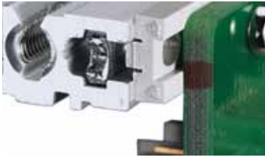
Монтаж объединительной платы с изолирующей полосой
